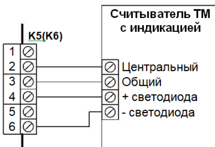
Пример 3: подключение считывателя Touch-Memo с индикацией
